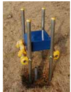
地盤沈下観測使用例
