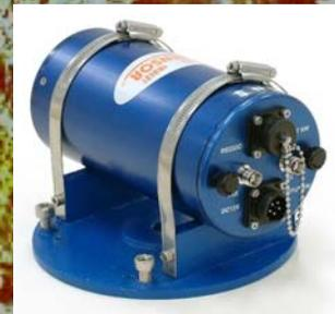
**優れた温度特性を持つセンサで地盤の傾きを測定する、データロガー一体型センサ！
