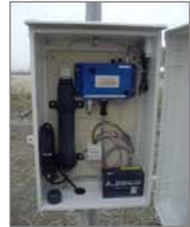
S&DL水位計との組み合わせによる地下水位観測使用例
