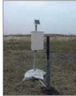
S&DL水位計との組み合わせによる地下水位観測使用例
